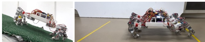
図10：プログラムJで坂(20°)に登る(左)と水平移動の様子(右)
