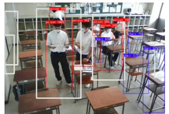
写真3：白枠が従前のシステムで、色枠が本システムでの検知
