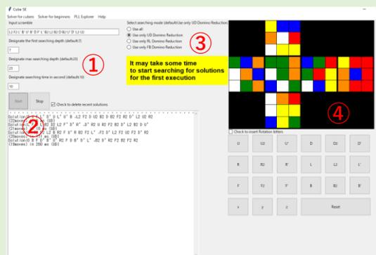
GUIの作成にはTkinterを用いた。GUI上のボタンを押すとC++で実装したexeファイルが実行され、受け取った出力をテキストボックスに表示させる。入力に対する例外処理や、ボタンの連打対策も実装した。
