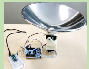
試作機2号(マイコンをNucleoに変更)
