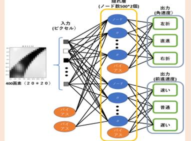
(方法) 右図のコースで右回り、左回りの教師データを5000個ずつ採取し編集を加えずネットワークを10000回学習させた。そして右図のコースの右回り、左回りそれぞれを100秒間走行させた。
