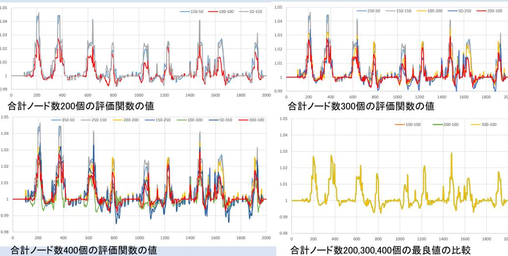
(考察) 合計ノード数が200個、300個、400個のネットワークでは隠れ層2層目のノード数が100個のもの(赤線)が最も良い値が出ていた。また、図3-4より合計のノード数に関係なく隠れ層2層目のノード数が100個のものは同じ性能であることがわかった。
