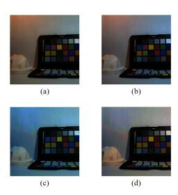
図 2: (a) 入力画像, (b) 入力画像の色補正結果, (c) 光源 色を統一した再構成画像, (d) 再構成画像の色補正結果
