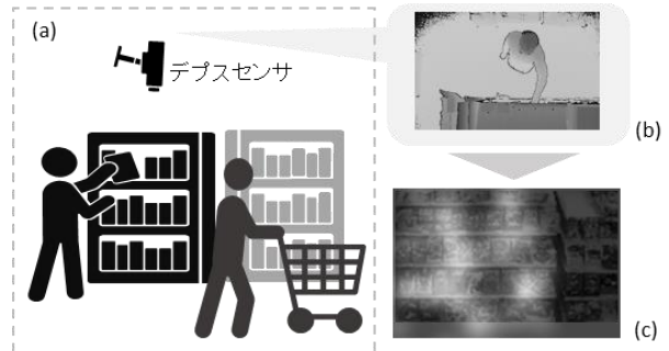
図 1 提案システムの模式図 (a)センサ設置, (b)デプス画像, (c) 棚ヒートマップ
