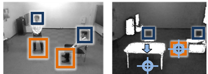
図4 足元検出(左)と気流の通り道検出(暖房時)(右)
