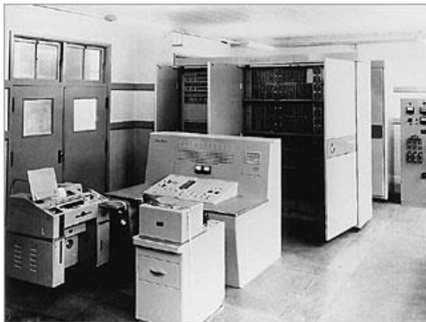
図2 東北大学に納入したデジタル式電子計算機 「SENAC-1」(日電名 NEAC-1102) 1958 年 11 月
