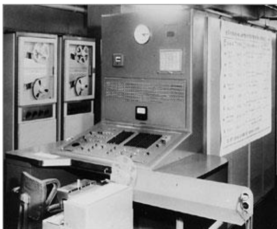
図3 濾波器設計用計算機「NEAC-1103」1960 年 (防衛庁技術研究所納入と同時に製作)
