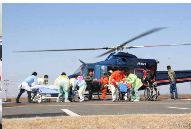
ヘリにより次々と運び込まれる患者。震災時はエレベーターが利用できない＝屋上ヘリポートは利用できない。沿岸部の災害拠点病院は陸上設置型ヘリポートが有効であることを実証した。
