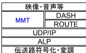
図 4 ATSC 3.0 規格候補版のレイヤーモデル
