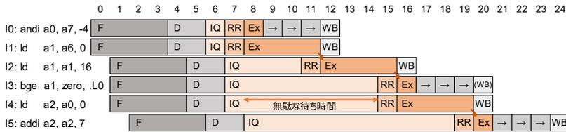
図 1 一般的な InO プロセッサのパイプラインチャート。F はフェッチステージ、D はデコードステージ、IQ は命令キューに入っている期間、RR はレジスタ読み出しステージ、Ex は実行ステージ、WB はレジスタ書き込みステージである。→は待機ステージで、ステージング [1] による InO 書き込みの実現のためのものである。
