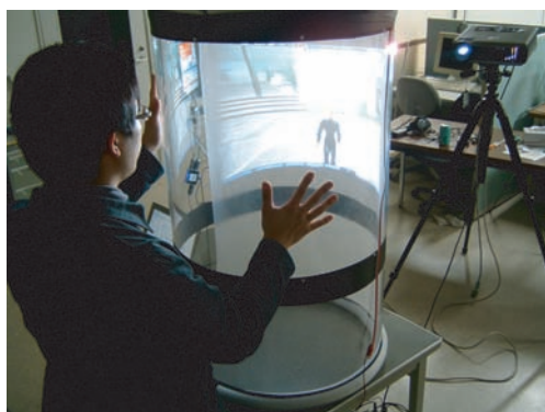
図 3: 円筒型マルチタッチインタフェース
